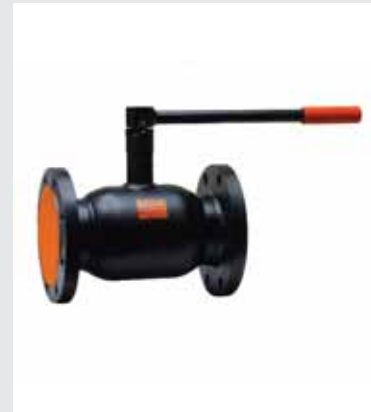
КШТ Серия 11/12, DN 65–100, PN 1,6/2,5 МПа Фланец/Фланец
